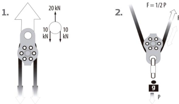
La polea debe ser utilizada solamente según las instrucciones y ninguna alteración se debe hacer a ella. Se puede utilizar junto con cualquier artículo adecuado de especificación adecuada y de acuerdo con las normas EN y teniendo en cuenta las limitaciones de cada equipo individual. La polea tiene que ser fijada a un anclaje seguro. La cuerda debe correr en la ranura de las poleas. (ver foto 3,4,5) También se recomienda usar guantes mientras se utilizan poleas.
